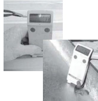
Positector 6000 muestra el espesor de Zn en una lámina galvanizada (33 micrones) comparado con el espesor de un galvanizado en caliente (260 micrones). Las capas de aleación Fe-Zn hacen la diferencia.
